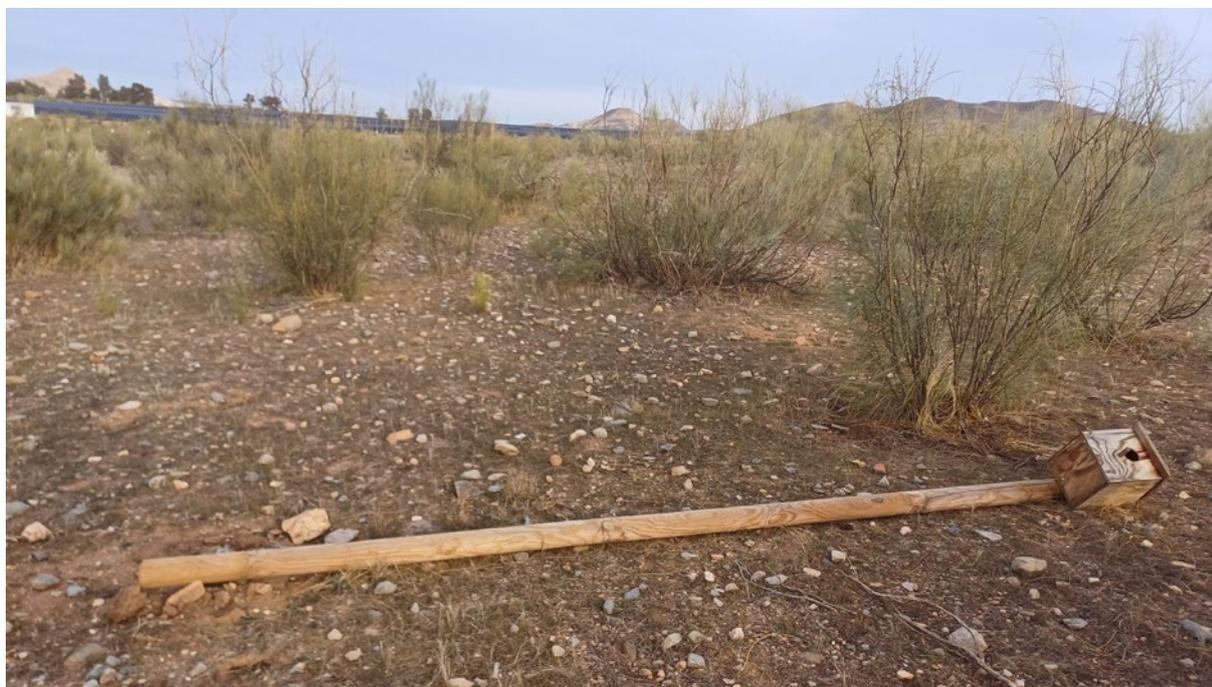
**Imagen 41.** Nidal para carraca europea instalado como medida compensatoria de una planta fotovoltaica en el Campo de Tabernas, Almería. El poste, sin cimentación, se cayó durante la primera primavera en que estuvo instalado, cuando estaba ocupado por una pareja de carracas (Autor: Luis Bolonio).
